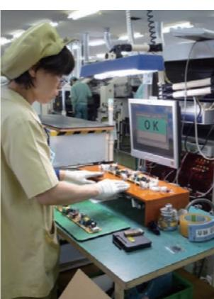
電子基板動作試験
