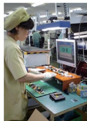
電子基板動作試験
