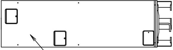
(2) タンク脚と下蓋・製品脚を締結しているボルト、ナットを外し、製品脚を取り外します。
