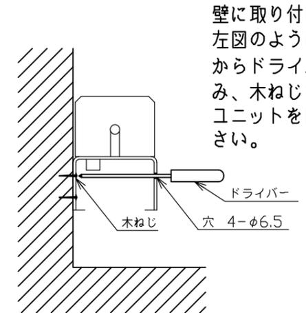
壁に取り付ける場合には左図のように反対側の穴からドライバーを差し込み、木ねじを締め付けてユニットを固定してください。
