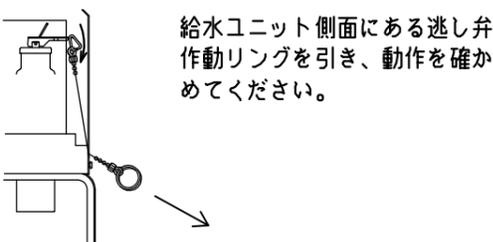
給水ユニット側面にある逃し弁作動リングを引き、動作を確認してください。
