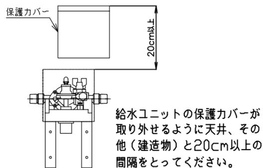
給水ユニットの保護カバーが取り外せるように天井、その他（建造物）と20cm以上の間隔をとってください。
