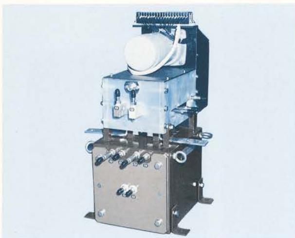
無電圧電動タップ切換器付全モールド高周波変圧器 (Fully Encapsulated High frequency Transformer with Motor Operated Tap-changer) 1~10kHz 1500kVA 1500/750~1500V 1000A
