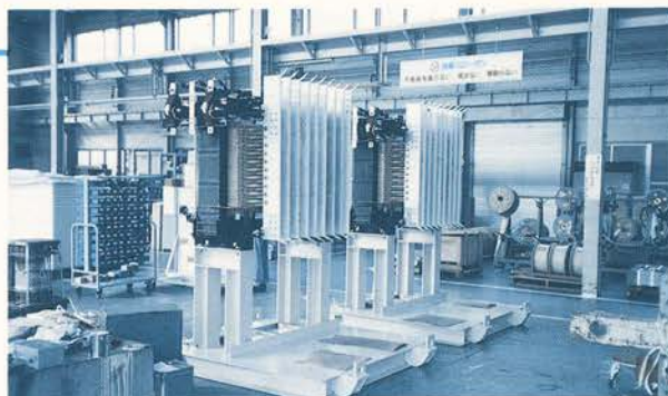
乾式風冷サイリスタ用変圧器 (Forced Air Cooled Dry Type Rectifier Transformer) 837/1184kVA 3300/24V
