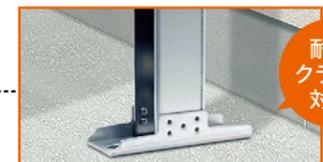
※370Lタイプ、460LタイプはクラスA対応。一般財団法人 日本建築センター「建築設備耐震設計・施工指針」における「局部震度法による建築設備機器の設計用標準震度」に基づいて設計。クラスS)設計用標準震度KH=2.0(満水質量の2倍の荷重)に耐えること。クラスA)設計用標準震度KH=1.5(満水質量の1.5倍の荷重)に耐えること。試験条件:満水の機器を所定の方法にて固定し、重心位置に対して弱軸方向へ連続的に荷重を加え、機器が設計用標準震度に耐えることを確認。
