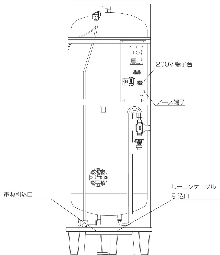
①電源ケーブルを電源引入口から通し、200V
