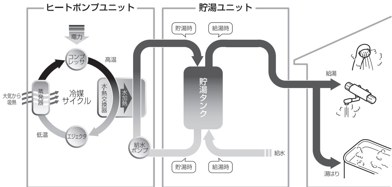
この給湯機は、1日に必要なお湯の量を学習し、電気代のお得な深夜にお湯を沸き上げて貯湯タンクに溜め、そのお湯を昼間に給湯やお風呂に使用することを基本としています。この給湯機の性能を最大限に発揮させ、経済的に運転するために電力会社と時間帯別電灯契約等(深夜電力B契約以外)を結んでいただく必要があります。
