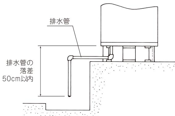
排水配管の落差が50cmを超える時は排水栓の下部50cm以内にホッパーを設け、大気開放になるよう排水配管してください。
