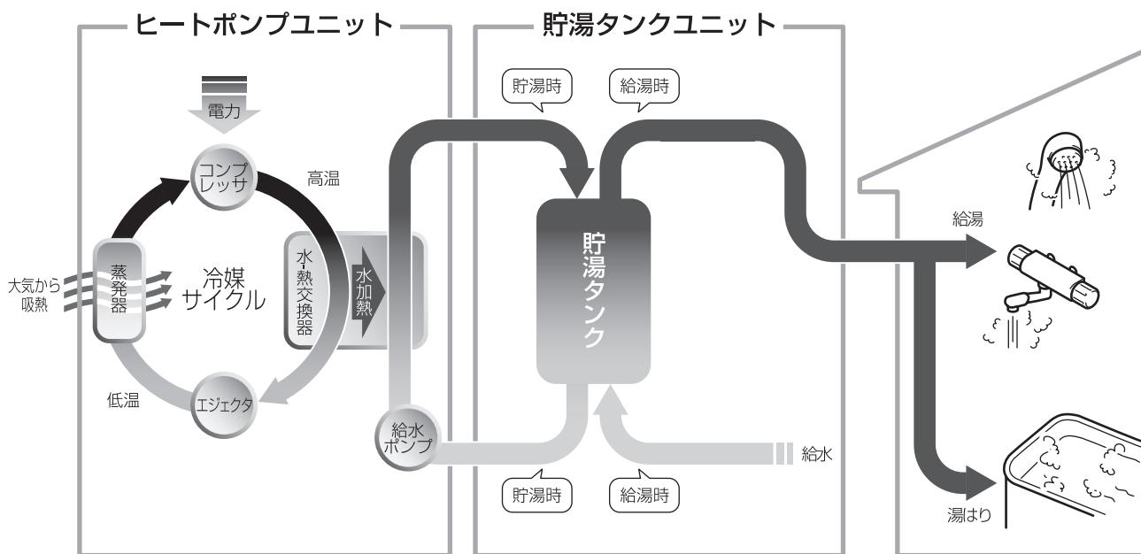
この給湯器は、1日に必要なお湯の量を学習し、電気代のお得な深夜にお湯を沸き上げて貯湯タンクに溜め、そのお湯を昼間に給湯やおふろに使用することを基本としています。この給湯器の性能を最大限に発揮させ、経済的に運転するために電力会社と時間帯別電灯契約を結んでいただく必要があります。
