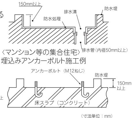
コンクリートの圧縮強度は $1.8\text{kN/cm}^2$ 以上、アンカーボルト引抜荷重： $12\text{kN}$ 以上にしてください。
