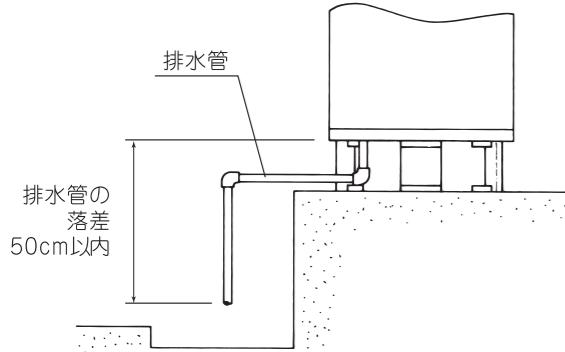
排水配管の落差が50cmをこえる時は排水栓の下部50cm以内にホッパーを設け、大気開放になるよう排水配管してください。
