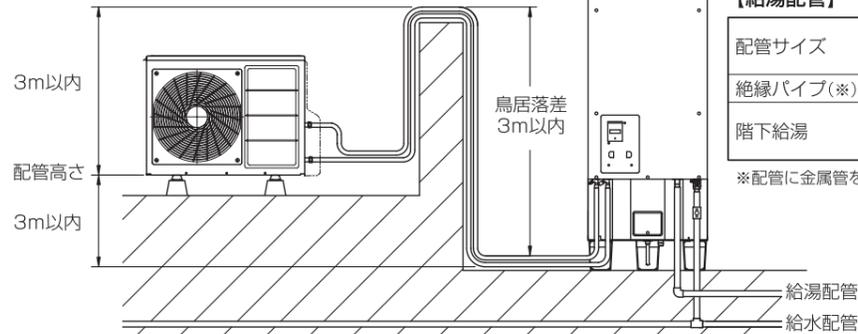
※深夜電力対応キット(別売部品)に同梱のヒートポンプ配管(凍結防止ヒータ付)は2mです。
