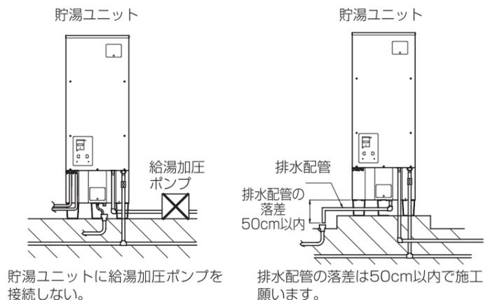
貯湯ユニットに給湯加圧ポンプを接続しない。
