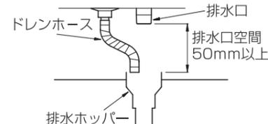
排水配管には必ず排水ホッパーを設置してください。
