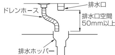
排水配管には必ず排水ホッパーを設置してください。
