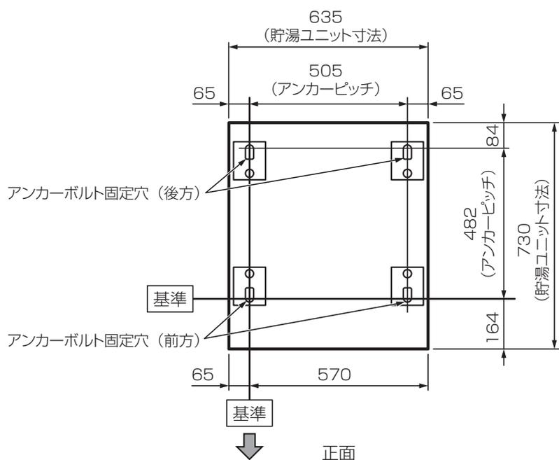
※貯湯ユニットの梱包材 (ダンボールに記載) をアンカーボルト位置および配線・配管立ち上げ位置の型紙としてご使用できます。
