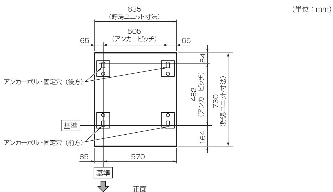
※貯湯ユニットの梱包材（ダンボールに記載）をアンカーボルト位置および配線・配管立ち上げ位置の型紙としてご使用できます。
