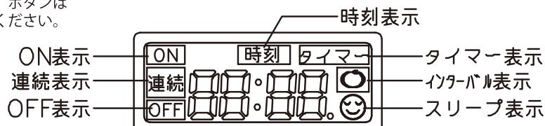
※タイムスイッチの液晶表示がない場合は通電後リセットボタンを押してください。
