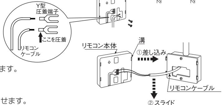
③リモコンにY型圧着端子 (リモコンケーブル) をねじ止めします。
