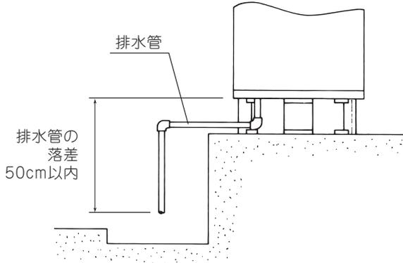
排水配管の落差が50cmをこえる時は排水栓の下部50cm以内にホッパーを設け、大気開放になるよう排水配管してください。
