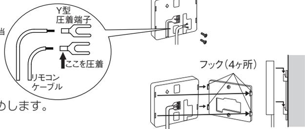
④リモコンにY型圧着端子 (リモコンケーブル) をねじ止めします。
