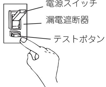
2. 動作確認後、必ず電源スイッチを「ON」にしてください。
