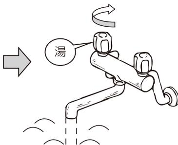
2バルブタイプの湯水混合栓を使用した後は、必ず湯側を先に閉める。（再度、湯水混合栓を使用する際にお湯が出て、やけどをすることがあります）
