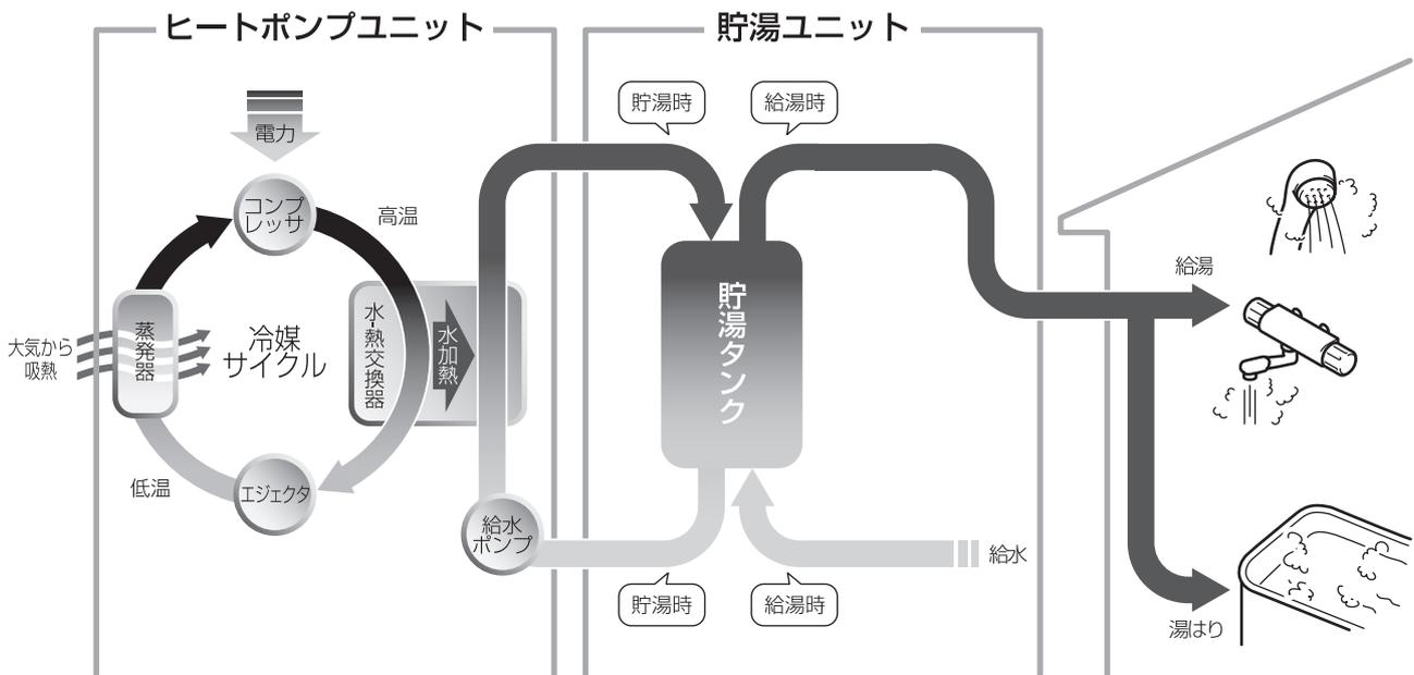
この給湯機は、1日に必要なお湯の量を学習し、電気代のお得な深夜にお湯を沸き上げて貯湯タンクに溜め、そのお湯を昼間に給湯やお風呂に使用することを基本としています。貯湯タンクに溜めたお湯を普段より多く使った場合には、昼間でも湯切れしないように自動で沸き増しします。また、ご使用になるお湯の量などに合わせて運転モードや最低貯湯量などを設定することもできます。
