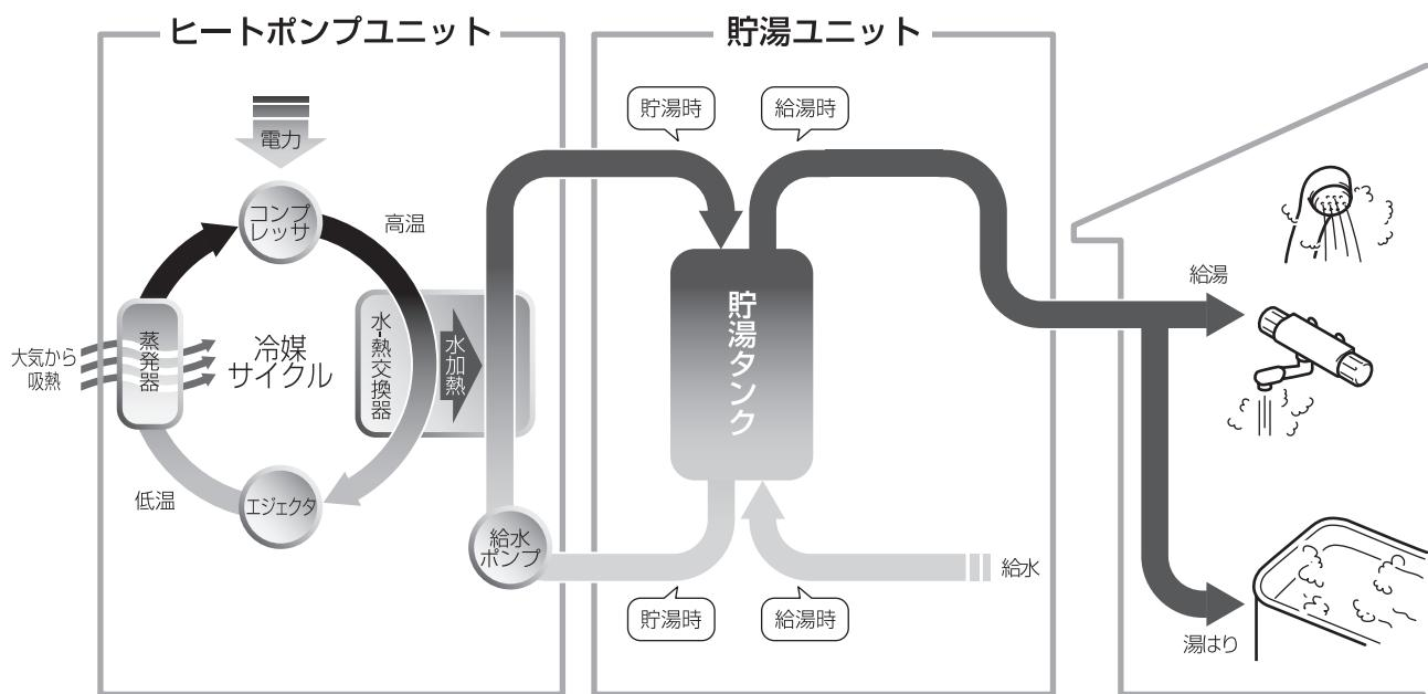
この給湯機は、1日に必要なお湯の量を学習し、電気代のお得な深夜にお湯を沸き上げて貯湯タンクに溜め、そのお湯を昼間に給湯やおふろに使用することを基本としています。この給湯機の性能を最大限に発揮させ、経済的に運転するために電力会社と時間帯別電灯契約を結んでいただく必要があります。
