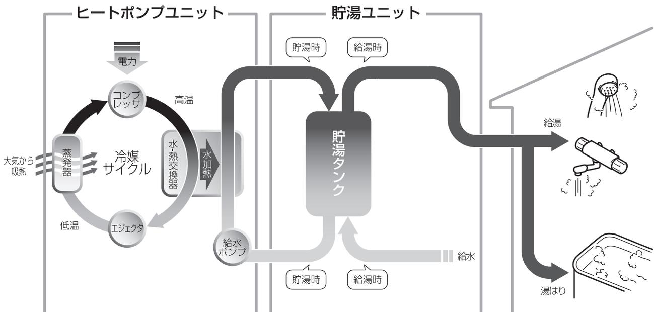
この給湯機は、1日に必要なお湯の量を学習し、電気代のお得な深夜にお湯を沸き上げて貯湯タンクに溜め、そのお湯を昼間に給湯やお風呂に使用することを基本としています。この給湯機の性能を最大限に発揮させ、経済的に運転するために電力会社と時間帯別電灯契約を結んでいただく必要があります。
