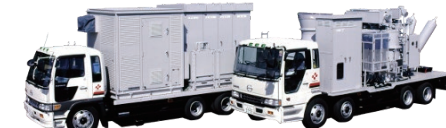
車載型受変電設備
