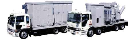
車載型受変電設備
