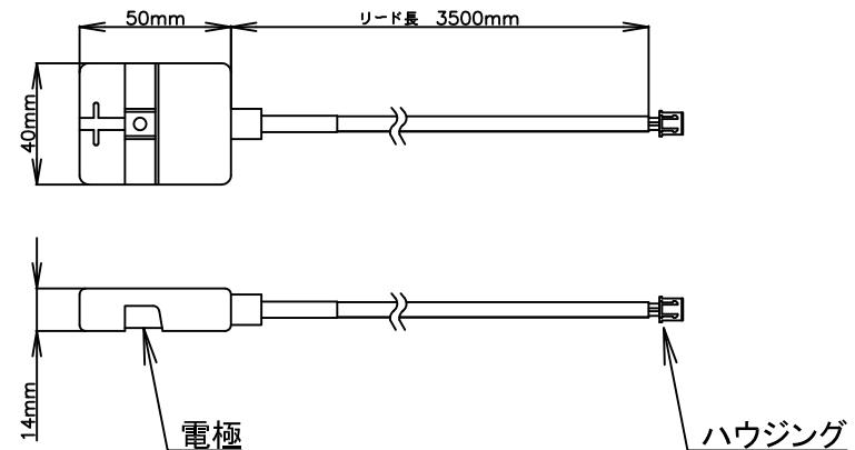
2. 漏水検知センサーを漏水を検知したい場所へ設置してください。
