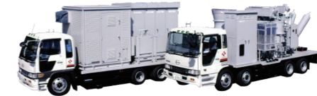
車載型受変電設備
