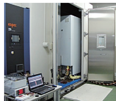
恒温槽を用いた環境耐久試験
